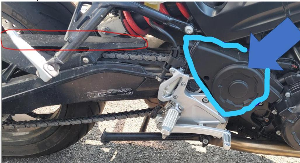
6.1.7.BM1/1/2 CHÂSSIS OU CADRE ET ACCESSOIRES : TRANSMISSION : Protection de la chaîne ou de la courroie - fixation altérée.
