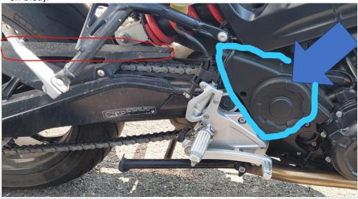
6.1.7.BM1/1/2 CHÂSSIS OU CADRE ET ACCESSOIRES : TRANSMISSION : Protection de la chaine ou de la courroie - fixation altérée.
